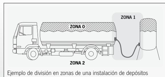
Ejemplo de división en zonas de una instalación de depósitos
