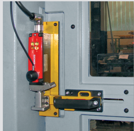
Absicherung einer Schwenktüre
