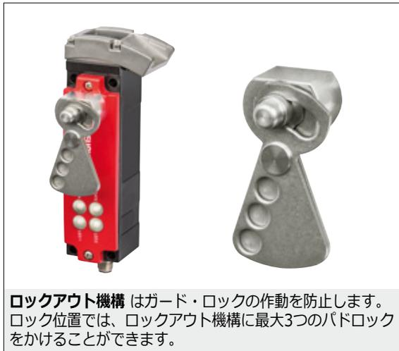
**ロックアウト機構** はガード・ロックの作動を防止します。ロック位置では、ロックアウト機構に最大3つのパッドロックをかけることができます。
