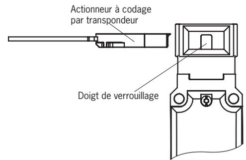
À la fermeture du protecteur, l'élément d'actionnement est introduit dans l'interrupteur de sécurité. Lorsque la distance de connexion est atteinte, l'actionneur est alimenté en tension par l'interrupteur et la transmission des données peut se dérouler.
