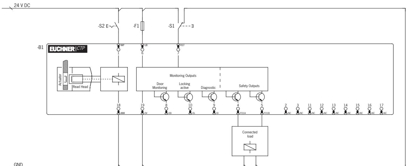
Figure 3 : Exemple de raccordement, version avec connecteur M23
