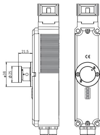
Avec système de déverrouillage par câble
