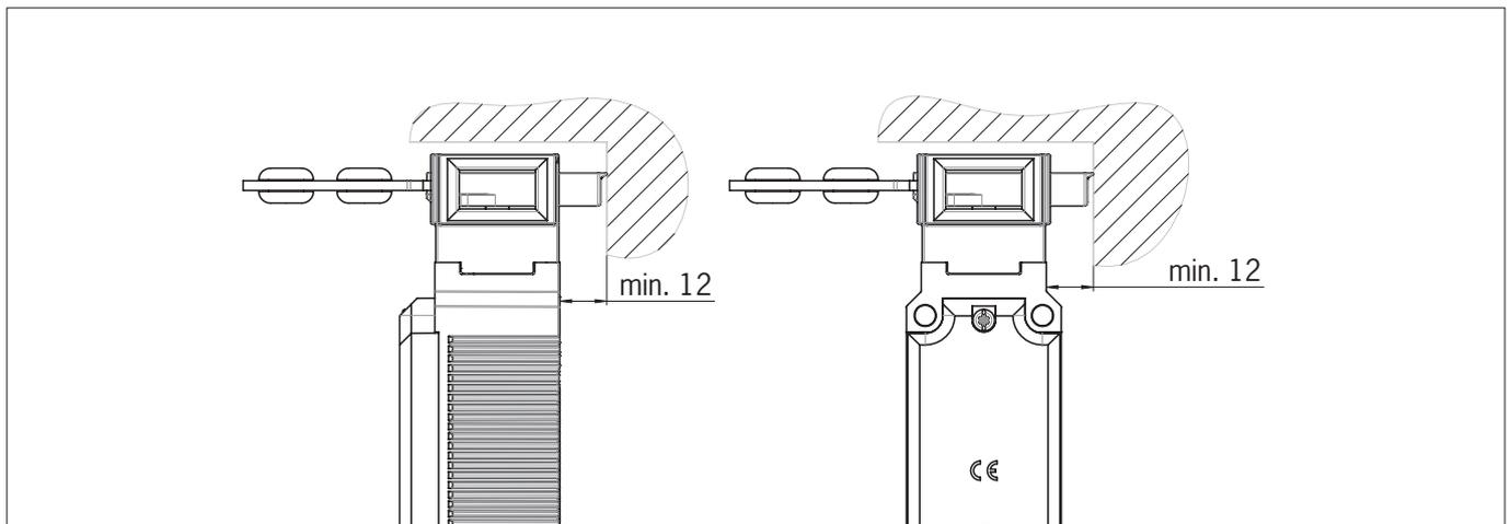
Bild 2: Freiraum Betätigerkopf
