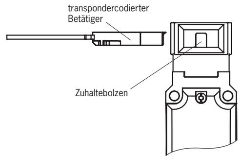
Beim Schließen der Schutzeinrichtung wird der Betätiger in den Sicherheitsschalter eingeführt. Beim Erreichen des Einschaltabstandes erfolgt über den Schalter die Spannungsversorgung zum Betätiger und die Datenübertragung erfolgt.
