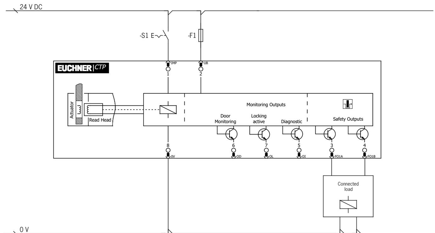
Figura 3: Esempio di collegamento, esecuzione con connettore M12
