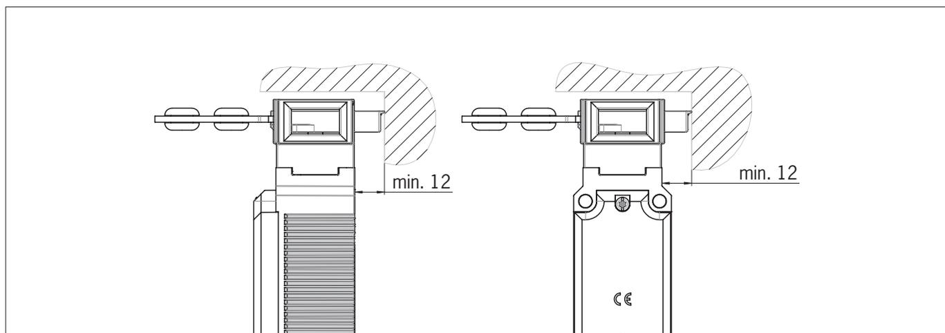
Figura 2: Spazio libero per la testina dell'azionatore
