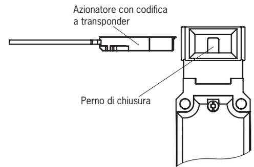
Alla chiusura del riparo, l'azionatore viene inserito nel finecorsa. Al raggiungimento della distanza di inserzione, l'azionatore viene alimentato attraverso il finecorsa dando inizio alla trasmissione dati.
