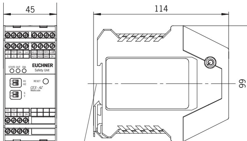
passend für Tragschiene 35 mm nach EN 60715
