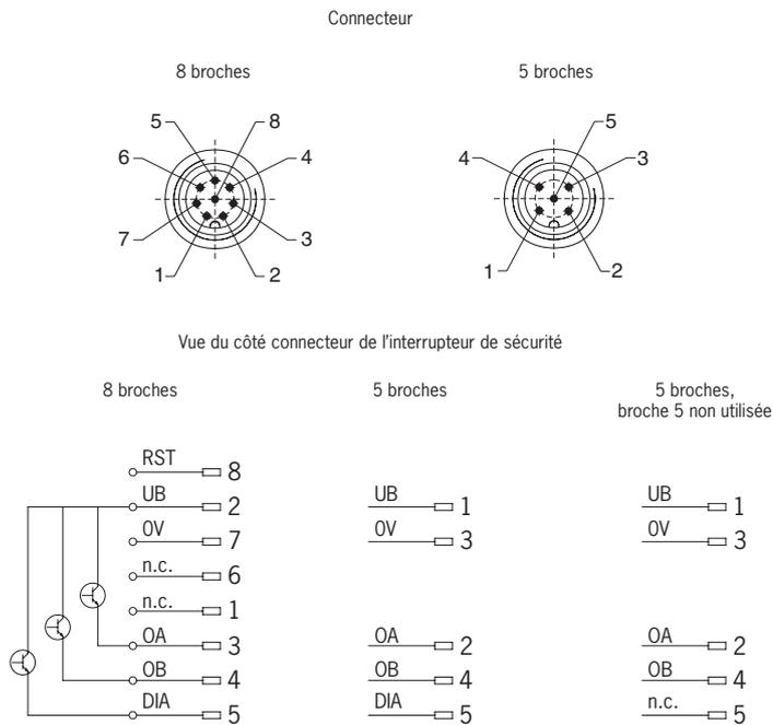
Figure 1 : Affectation des broches interrupteur de sécurité CES-AP-C01
