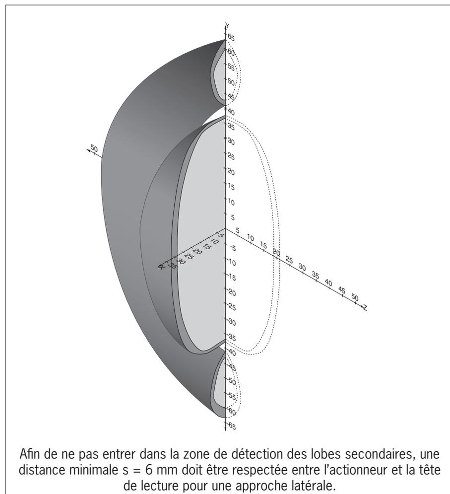
Figure 8 : Zone de détection type
