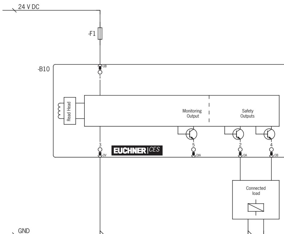
Figure 2 : Exemple de raccordement CES-AP-...
