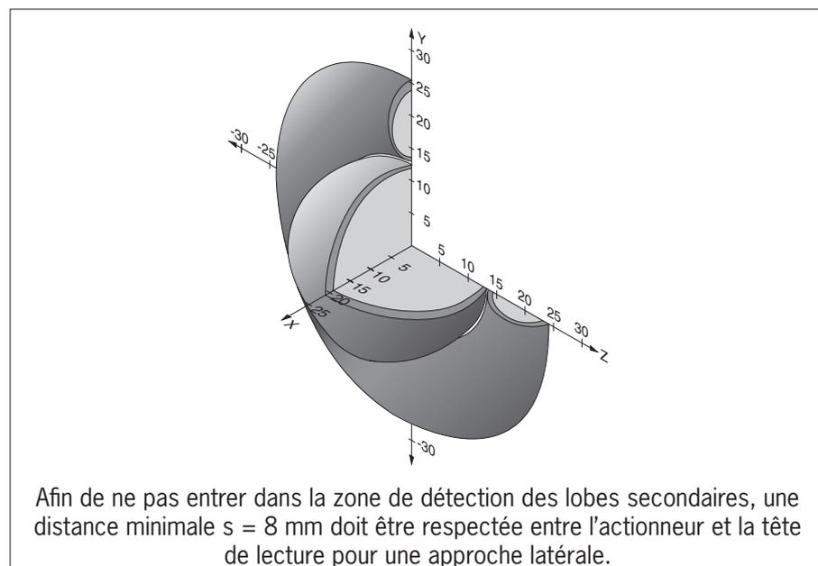
Figure 6 : Zone de détection type
