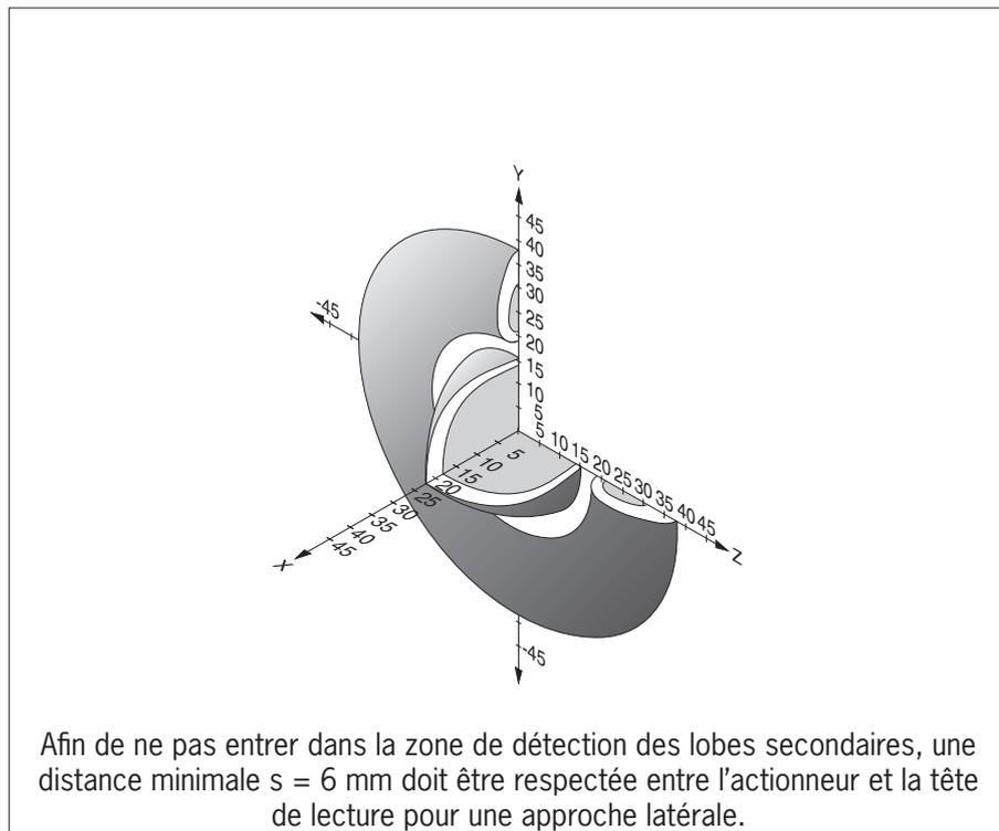
Figure 7 : Zone de détection type
