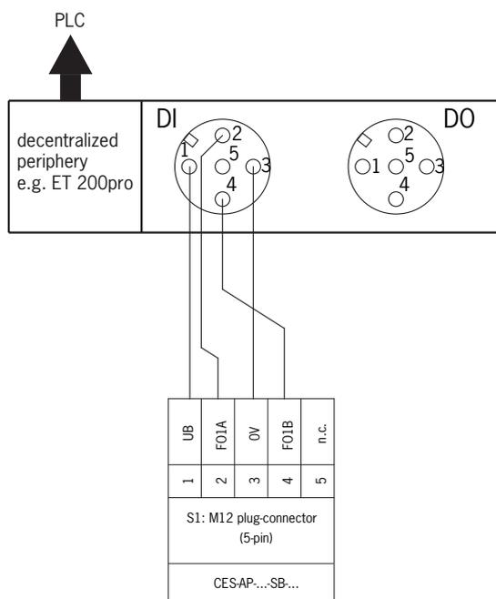
Figure 4 : Exemple de raccordement version pour modules d'interfaces décentralisées
