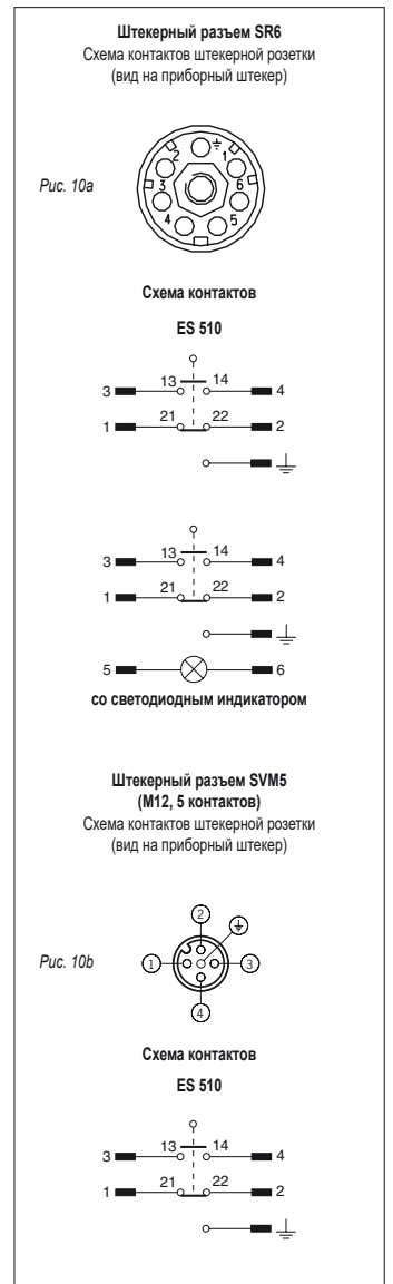
Рис. 10. Коммутирующие элементы и схема контактов штекерного разъема
