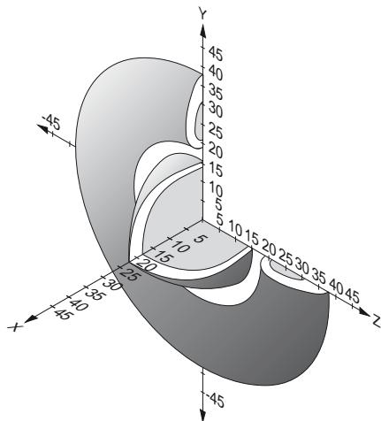
Чтобы не попасть в зону срабатывания боковых лепестков, при боковом направлении пуска исполнительного ключа и считающей головки должно быть соблюдено минимальное расстояние  $s = 6$  мм.
