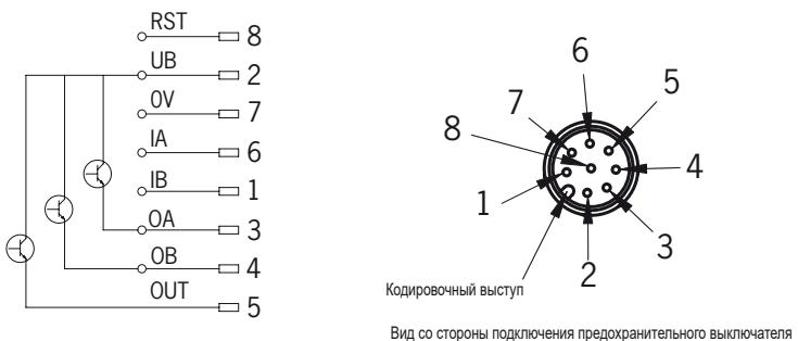
Рис. 2. Схема контактов штекерного разъема предохранительного выключателя CES-AR
