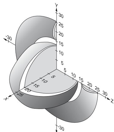
Чтобы не попасть в зону срабатывания боковых лепестков, при боковом направлении пуска исполнительного ключа и предохранительного выключателя должно быть соблюдено минимальное расстояние  $s = 4$  мм.
