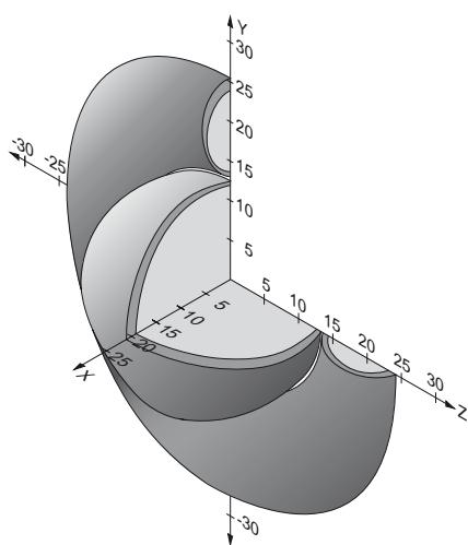
Чтобы не попасть в зону срабатывания боковых лепестков, при боковом направлении пуска исполнительного ключа и считающей головки должно быть соблюдено минимальное расстояние  $s = 8$  мм.
