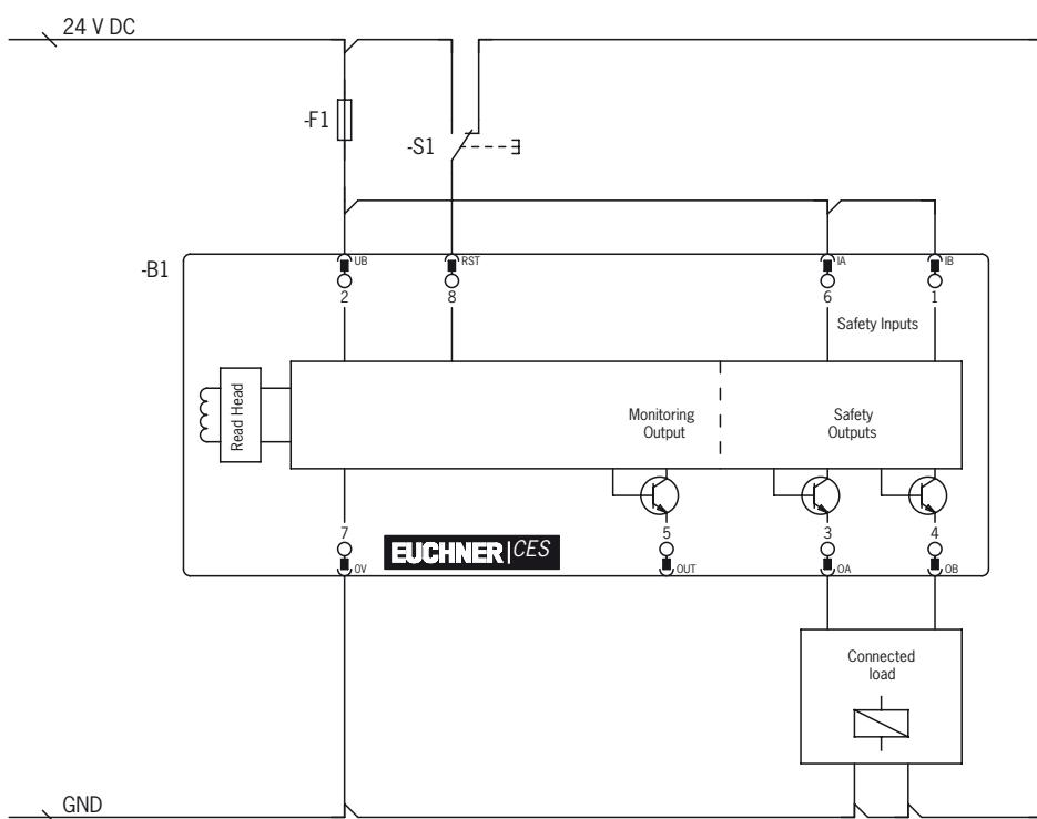
Рис. 3. Пример подключения для отдельного устройства CES-AR-...
