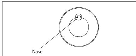
Vor dem Einbau des Typenschildes Nase an dem Typenschild mit einer Zange abbrechen.
