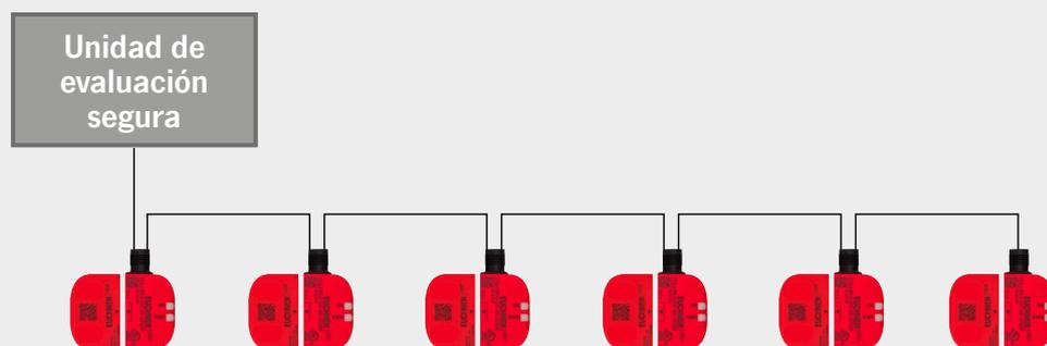
Conexión al módulo de seguridad ESM-CB
